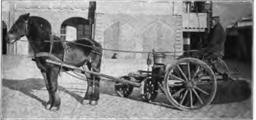
Abb. 122. Kebrmaschine mit Besenwalze.
